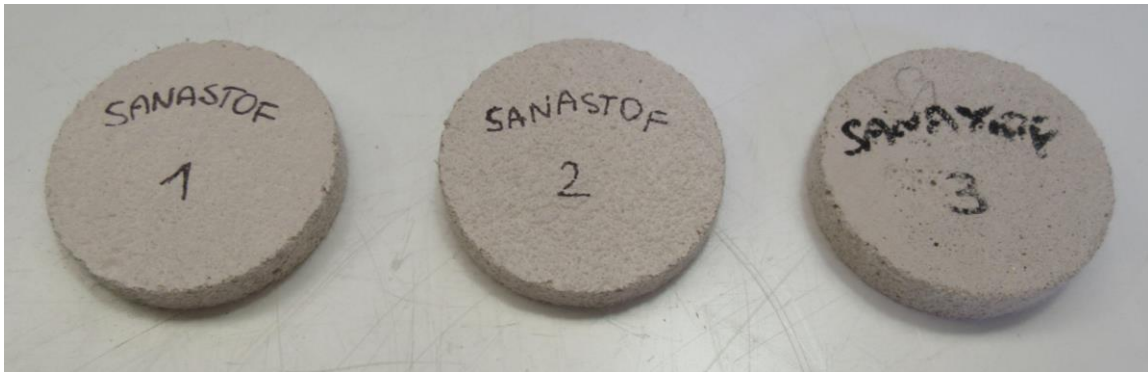
Figura 2. Provini per la misura di conducibilità termica.
